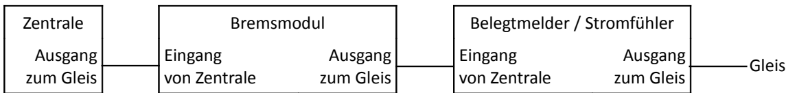
Abbildung 5: Zentrale → Bremsmodul → Belegtmelder → Gleis (Prinzip 1)
