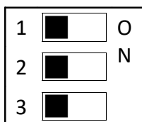
Schematische Darstellung des DIP-Schalters, alle Schalter in Position Aus.
